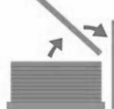
Zabranjeno je da paneli pokriveni zaštitnom folijom budu direktno izloženi sunčevim zracima. Zaštitna folija nije otporna na UV zračenje, te mora se skinuti odmah nakon montaže, najkasnije 7 dana nakon postavljanja.
