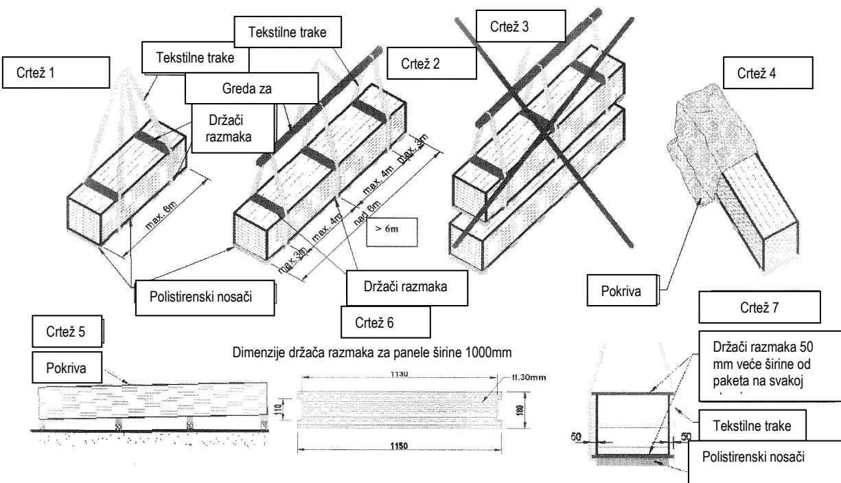
Zabranjeno je uhvatiti i podići samo jednu stranu (spoljni/unutrašnji suport), zbog rizika da se otcepi od unutrašnjosti PUR/PIR. Ručno podizanje panela mora se vršiti podizanjem panela iz paketa na bočnoj strani, izbegavajući kontakt sa sledećim panelom. Individualno podizanje panela, kao i skidanje zaštitne folije, može vršiti samo obučeni kada.
