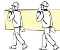
Uvek upotrebite rukavice i zaštitno odelo, posebno obratite pažnju na oštре ivice i uglove. Nemojte stajati ispod valovitog lima dok se prenosi. Pre podizanja proverite Da li su kuke pričvršćene na pravilnim pozicijama kako bi držale celu težinu paketa. Izbegavajte prenos ploča dok duva jak vetar.
