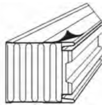
Fig. 7 Ridicarea foliei de protectie de pe captuseala interna a panourilor.
