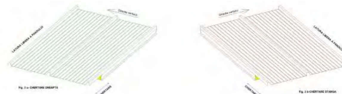
Fig. 13 Determinarea pozitionarii chertarilor in functie de directia de montaj
