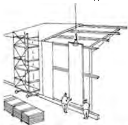
Fig. 15. Așezarea panourilor pentru pereți cu ajutorul macaralei.
