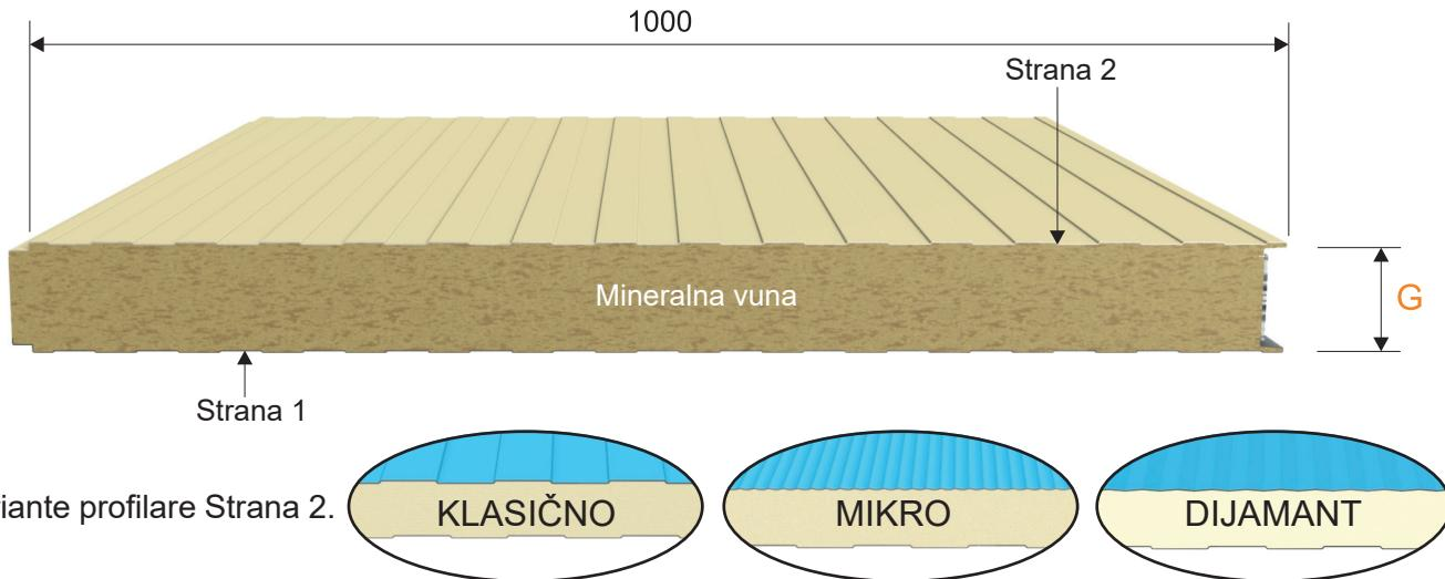
Zavisno od debljine izolacije, vatrootpornost panela je od:
