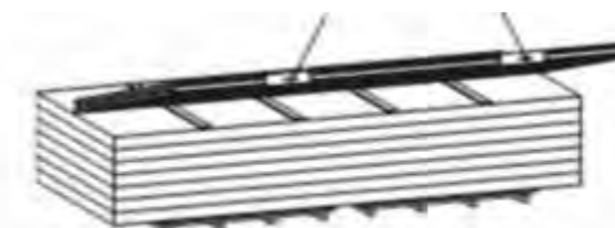
Fig. 24. Etapa 2 - Așezați distanțere sub panoul ridicat pentru a nu detenora alt panou și ridicați-l cu atenție.
