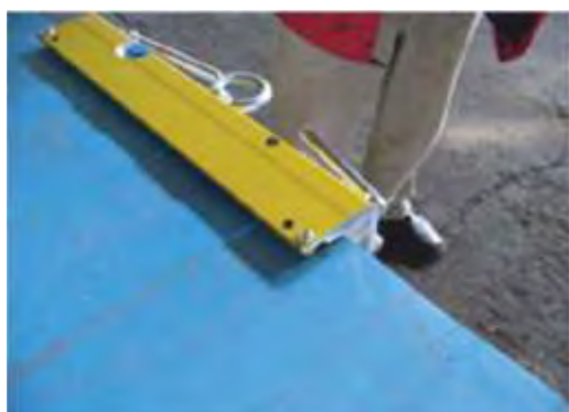
Imagine 6 Dispozitiv de ridicat pentru panourile termoizolante cu aranjarea panoului in pozitie verticala.
