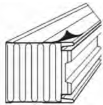
Fig. 7 Ridicarea foliei de protectie de pe captuseala interna a panourilor.
