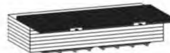
Fig. 23. Etapa 1 - Luați panourile din pachet și puneți dispozitivul de fixare sau dispozitivul de ridicare în mod sistematic pentru a centra panourile.
