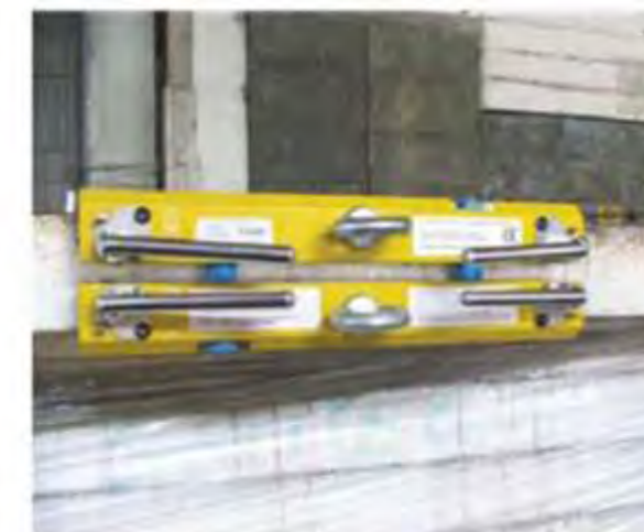
Imaginea 9. Folosirea dispozitivelor de ridicat pentru panourile termoizolante cu aranjarea pe verticală a panoului cu L \leq 6 m.
