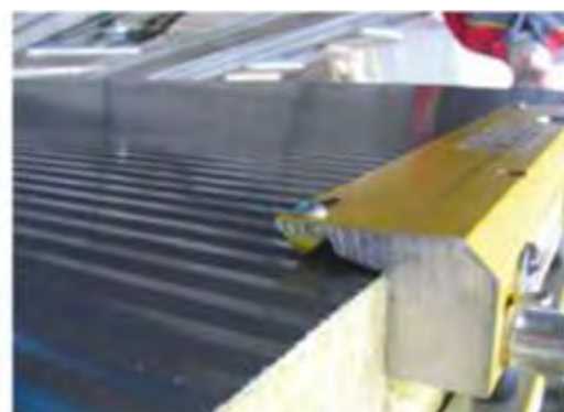
Imagine 7 Dispozitiv de ridicat pentru panourile termoizolante cu aranjarea panoului in pozitie verticala.
